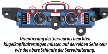
Chassis-T-Lock-Servohalterung
