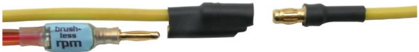
**Die Brushless Drehzahlmessung funktioniert nur, wenn der **UniLog 2** gleichzeitig über den Stromsensor auch eine Masseverbindung zum Antrieb hat.**
