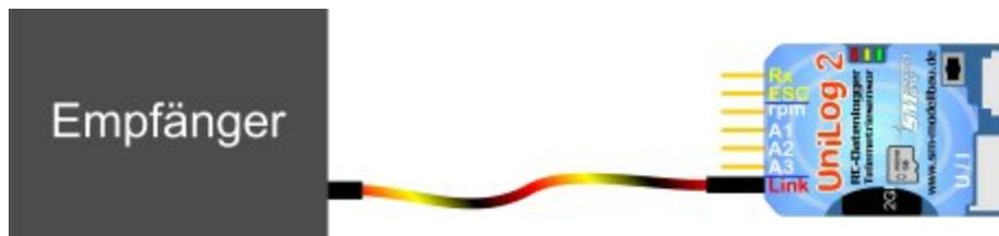
Wenn per Sender die Aufzeichnung gestartet und gestoppt werden soll (bei aktiviertem RxStart) ist noch eine zweite Verbindung zwischen dem gewünschten Empfängerkanal und dem Rx Eingang des **UniLog 2** nötig.
