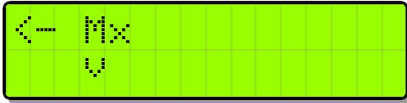
An der **JetiBox** wird nach dem Start von Tx über Rx zu Mx für die angeschlossenen Sensoren gewechselt.
