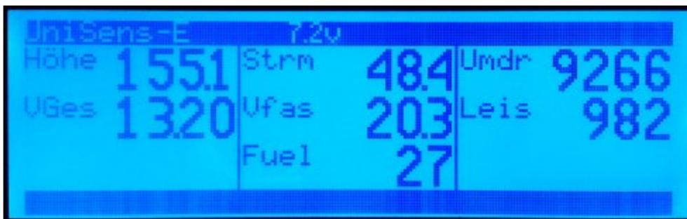
Alle Werte können direkt dargestellt werden, die Reihenfolge am Display ist frei wählbar.
