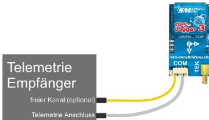
Der **GPS-Logger 3** wird direkt am Telemetrieanschluss angeschlossen.
