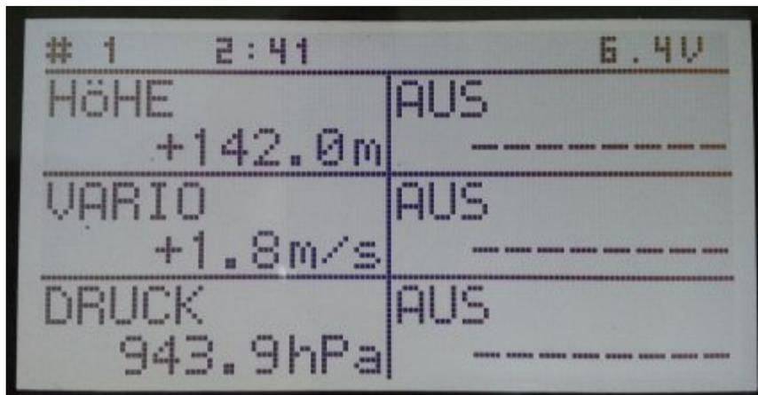
Alle Werte können direkt dargestellt werden, die Reihenfolge am Display ist frei wählbar.
