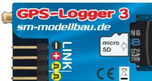
Die Karte wird in den Ausschnitt auf der Rückseite eingeschoben bis sie mit der Platine bündig ist. Der **GPS-Logger 3** hat keinen Auswurf für die Speicherkarte, sie wird einfach mit dem Finger wieder heraus gezogen. Bei Bedarf hilft hier auch ein kleiner Streifen Klebeband
