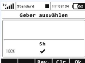
Der Schaltvorgang am Sender kann mit jedem beliebigen Schalter ausgelöst, und per Taste am Display bestätigt werden. Somit kann das Modell nicht aus Versehen abgeschaltet werden. Per Audiofile (Download in unserem Forum), kann man den Schaltvorgang akustisch bestätigen lassen.
