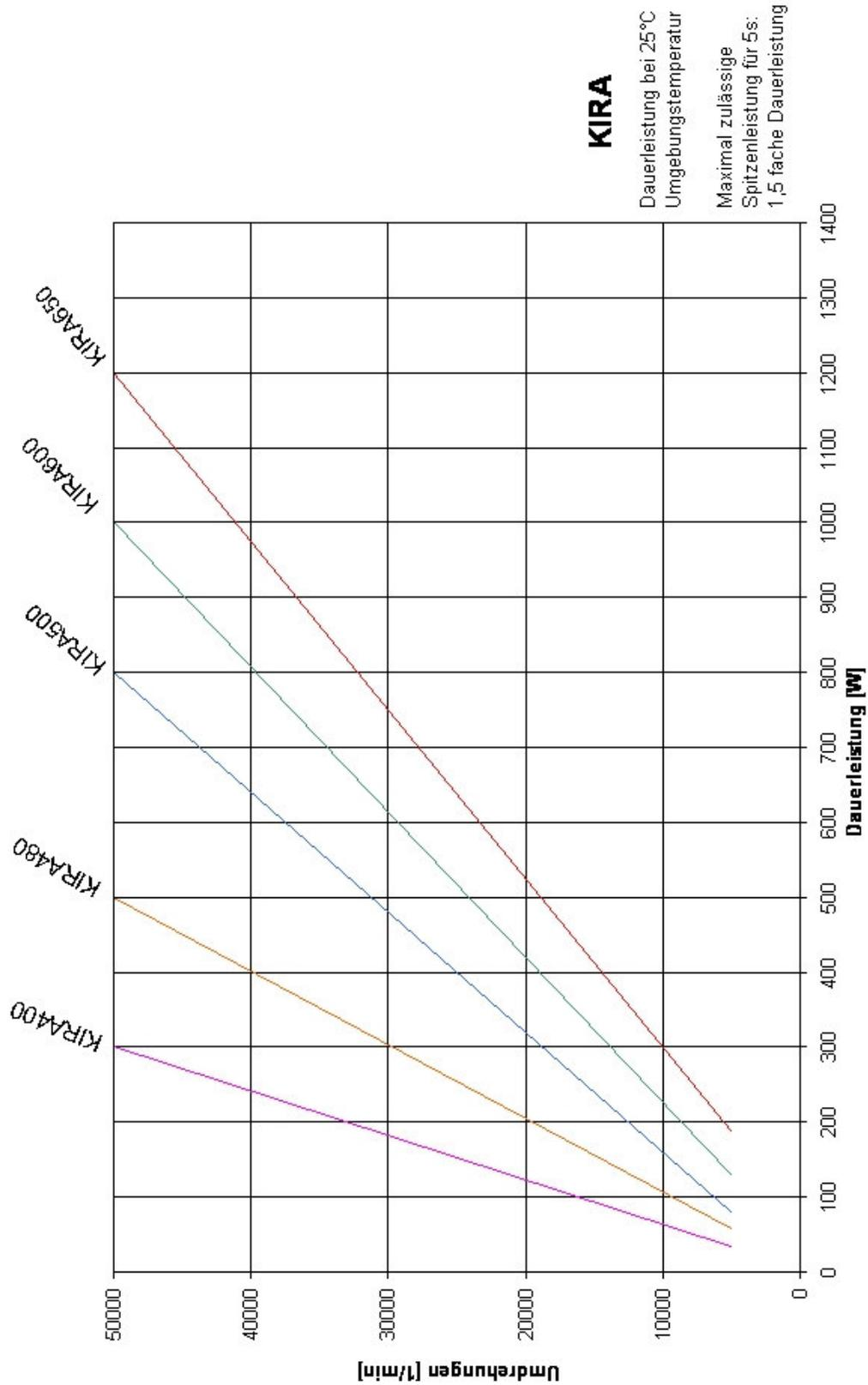
Die Dauerleistung ist die zulässige Leistung in Abhängigkeit der Drehzahl des Motors bei 25°C Raumtemperatur. Bei höheren Temperaturen nimmt die Belastbarkeit ab. Eine Überlastung des Motors führt zur Zerstörung der Wicklung und der Magnete.
