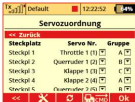
Fig. 13: Geräteübersicht-Servo Output Mapping
