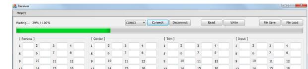
Drücken und halten Sie den **SET**-Taster des Empfängers und schalten diesen nun ein. Nach ca. 3 s werden die aktuellen Werte des Empfängers in den entsprechenden Feldern angezeigt.
