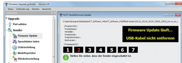
Anschließend wird der Update-Vorgang abgebrochen. Zunächst finden Sie nach geraumer Zeit im „[Prozessschritt] 4“ die Meldung „Paketrückmeldung Zeitüberschreitung“ ...
