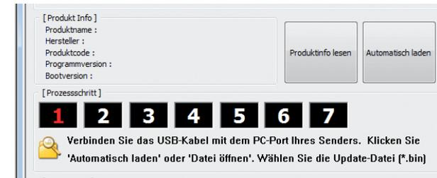
Beispielsweise beim hier abgebildeten Step 1: „Verbinden Sie das USB-Kabel mit dem PC-Port Ihres Senders.“
