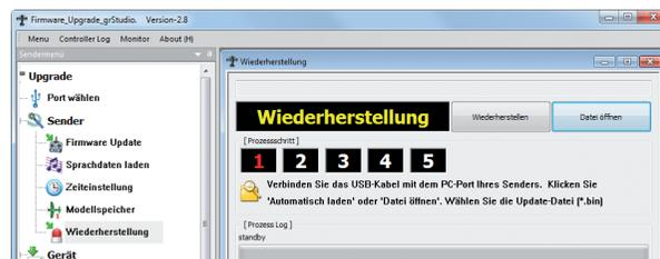
Nach dem Programmaufruf signalisiert die rot blinkende „1“ der Zahlenreihe 1 ... 5 im Kopf des Fensters, dass sich das Programm derzeit im „[Prozessschritt] 1“ befindet.
