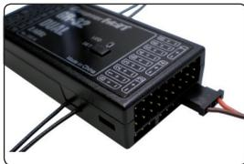
Stecken Sie das Adapter-Kabel wie in der Abb. gezeigt in die Telemetrie-Buchse „T“ des Empfängers. Das Stecksystem ist verpolungssicher, achten Sie auf die kleinen seitlichen Fasen. Wenden Sie auf keinen Fall Gewalt an, der Stecker sollte leicht einrasten.
