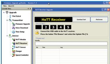
Starten Sie das Firmware Update Graupner Studio. Wählen Sie unter „Port Select“ den korrekten COM-Port „Silicon Labs CP210x USB to UART Bridge“ aus, an dem das USB-Kabel angeschlossen ist.
